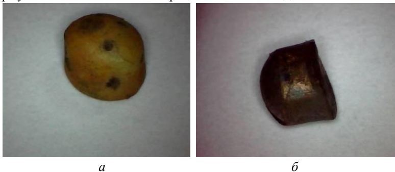
Рис. 21.2. Фотографії гранул ПВХ пластикату після металізації за класичною технологією. Травильний агент: а) чотирихлористий вуглець, б) хромова суміш.
